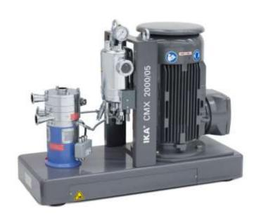
Поточный смеситель СМХ 2000 эффективно и гомогенно вводит порошки в жидкости, надежно и последовательно смешивает их в режиме рециркуляции. Его многоступенчатая конструкция и уникальная прокачивающая ступень обеспечивают приготовление высоковязких продуктов без какихлибо дополнительных устройств.
