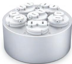
Реакционный блок с 6 разделенными ячейками
